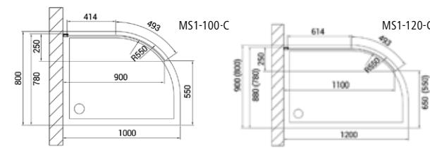
**ARCHITEX LINE** jsou elegantní walk-in sprchové zástěny bez klasických profilů. Skla jsou uchyceny pomocí neviditelných profilů **zapuštěných do keramického obkladu**. Bezpečnostní sklo 8 mm s leštěnou hranou a povrchovou úpravou ANTIDROP.
